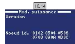
10.14 Infos système. Informations sur la version du logiciel de l'écran TFT et du module de puissance. Cet écran indique également l'identifiant du nœud nécessaire à la configuration de la connexion WIFI.
