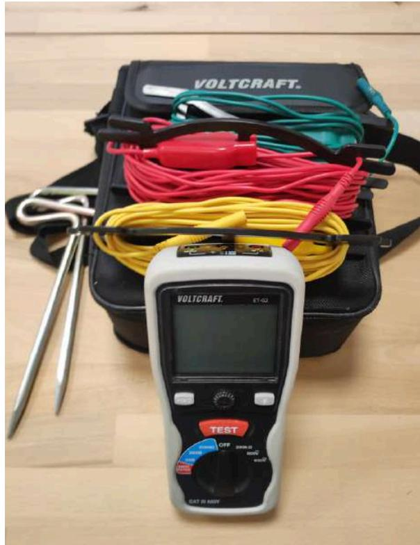
Telluromètre / Mégohmmètre
