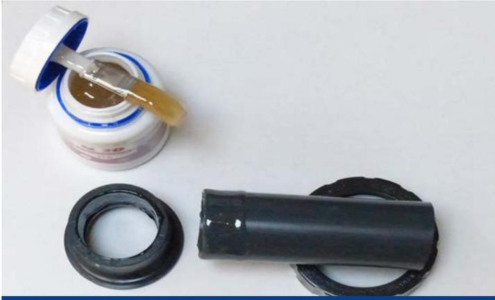
7- Détail collage raccordement filtre
